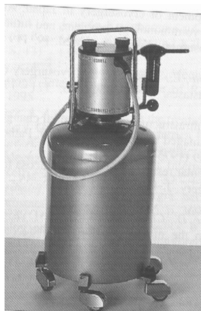
Рис. 12. Немецкая криоустановка, разработана с участием проф. Бушмана (фирма ERBOCRYO)
